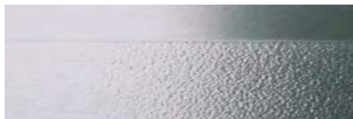
Рисунок 3 - Поверхность направляющей, обработанная ПВДО
