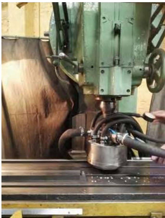
Рисунок 2 - Установка инструмента для ПВДО на фрезерном станке
