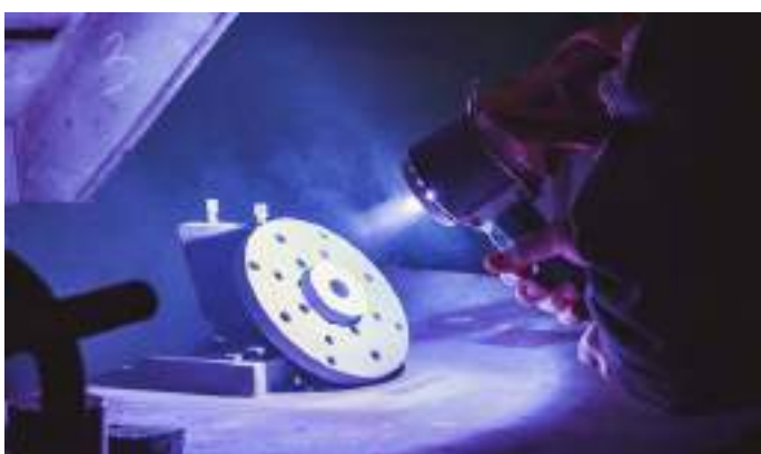
Рисунок 2 - ЭЛЕКТРОДУГОВАЯ МЕТАЛЛИЗАЦИЯ, гарантия защиты от коррозии - 4 года!
