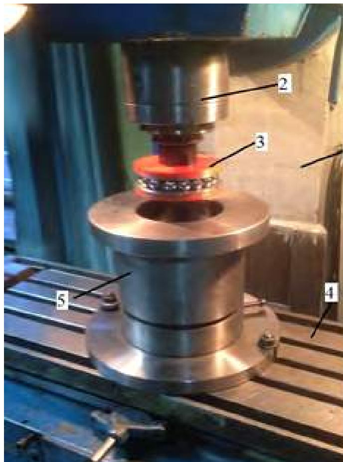
1 - вертикально-фрезерный станок; 2 - шпиндель; 3 - комбинированный инструмент; 4 - стол станка; 5 - технологическое приспособление
