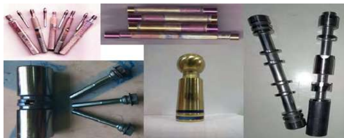
Рисунок 2 - Детали прецизионных пар трения и инструмент с модифицирующими покрытиями
