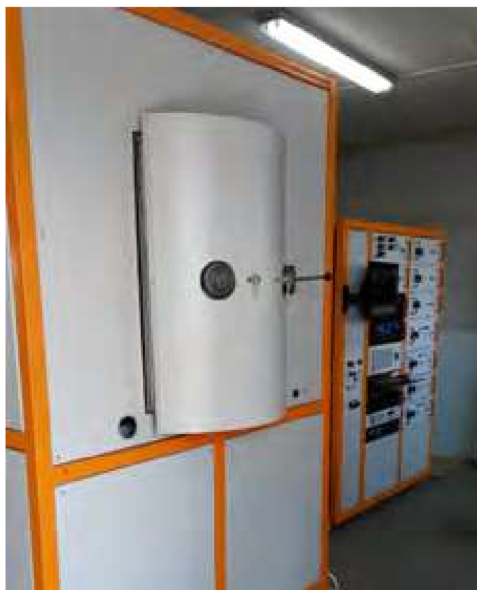
Рисунок 1 - Установка вакуумно-плазменного модифицирования
