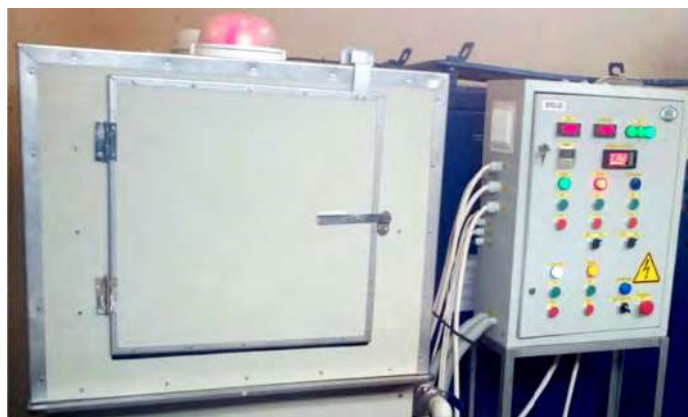
Рисунок 3 - Оборудование для финишной обработки изделий из сплавов титана методом ЭПО
