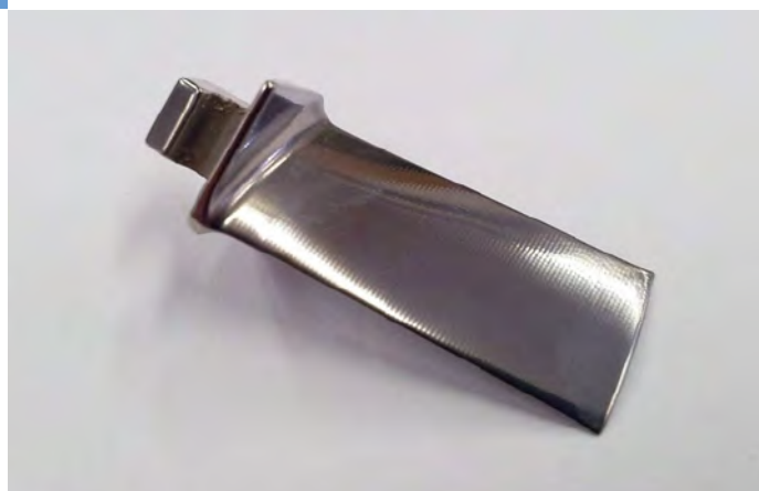
Рисунок 1 - Турбинная лопатка для авиационного двигателя из титанового сплава BT6
