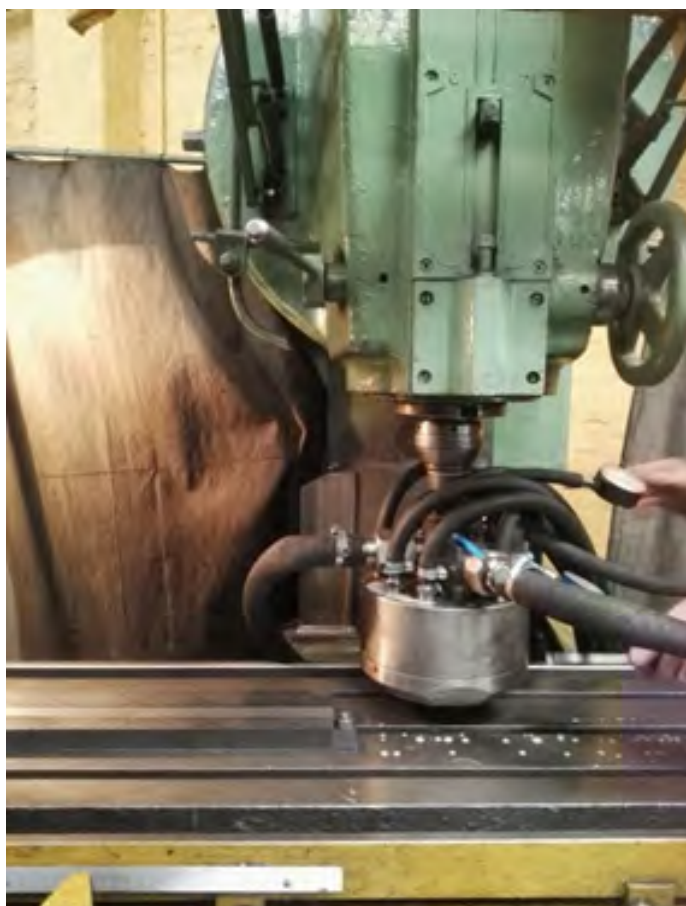
Рисунок 2 - Установка инструмента для ПВДО на фрезерном станке
