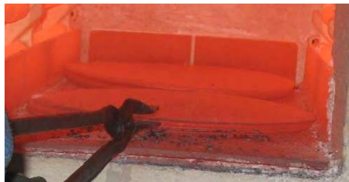
Фото 2 – Выгрузка из нагревательной печи
