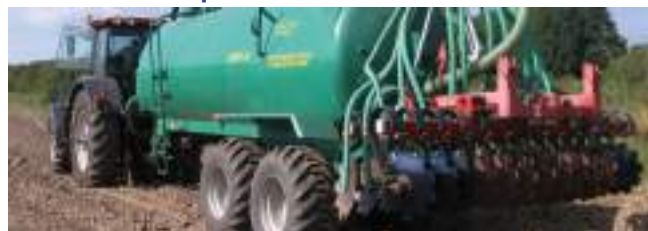
Рисунок 50. Машина для поверхностного и внутрипочвенного внесения жидкого навоза МПВУ-16
