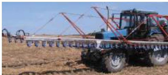
Рисунок 46. Распределитель штанговый минеральных удобрений РШУ-18 (вид спереди)
