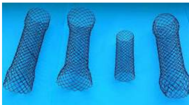
Рисунок 13. Образцы TiNi стентов с различной формой окончаний
