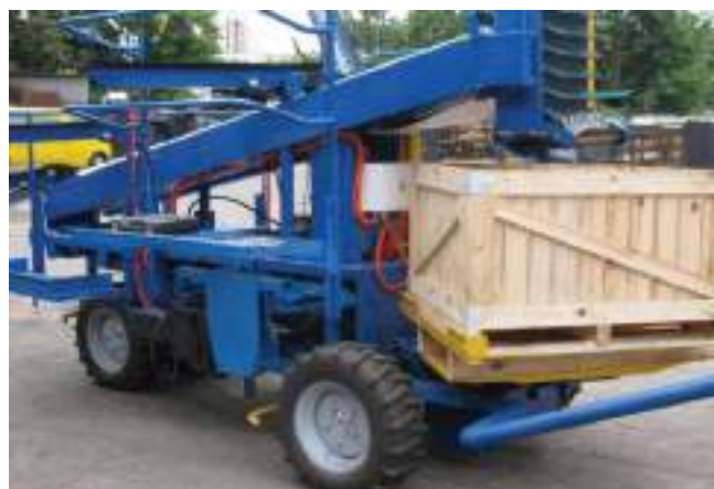
Рисунок 57. Агрегат самоходный универсальный с поточным контейнеровозом для сбора плодов и формирования кроны семечковых культур АСУ-6 (вид сзади сбоку)
