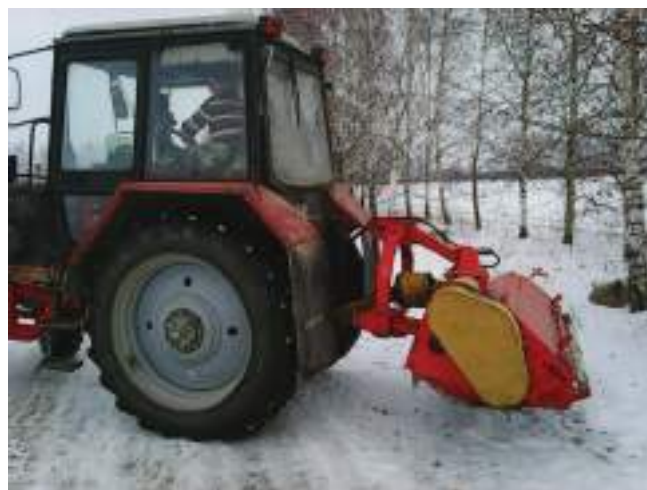
Рисунок 64. Комплекс уборки веток плодовых деревьев КУВ-1,8 (измельчитель веток)
