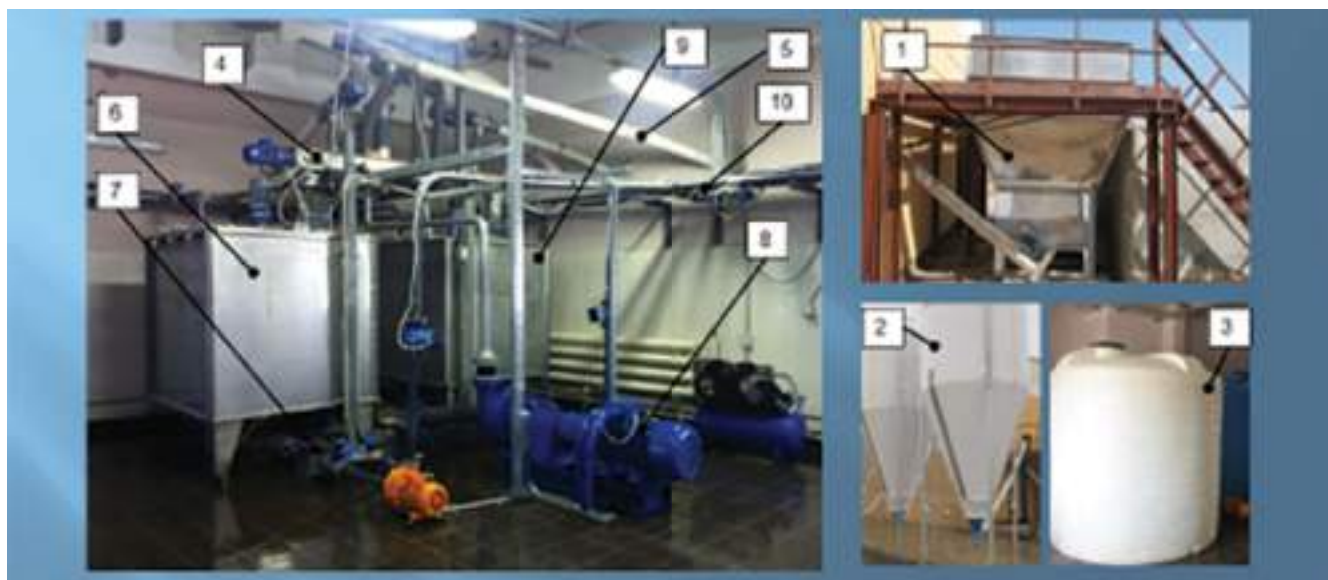
Рисунок 53. Комплект оборудования для приготовления кормовой добавки на основе консервированного влажного зерна кукурузы
