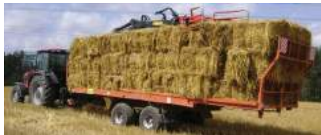
Рисунок 66,67. Платформа с манипулятором для подбора и транспортировки кормов ПМК-10
