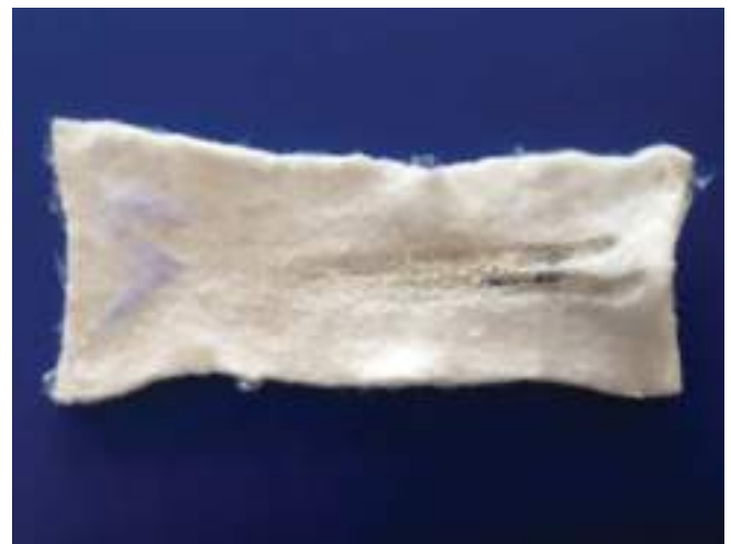
Рисунок 32. Образцы полиэфирной нетканого материала после огневого испытания (после ступенчатой огнезащитной обработки)
