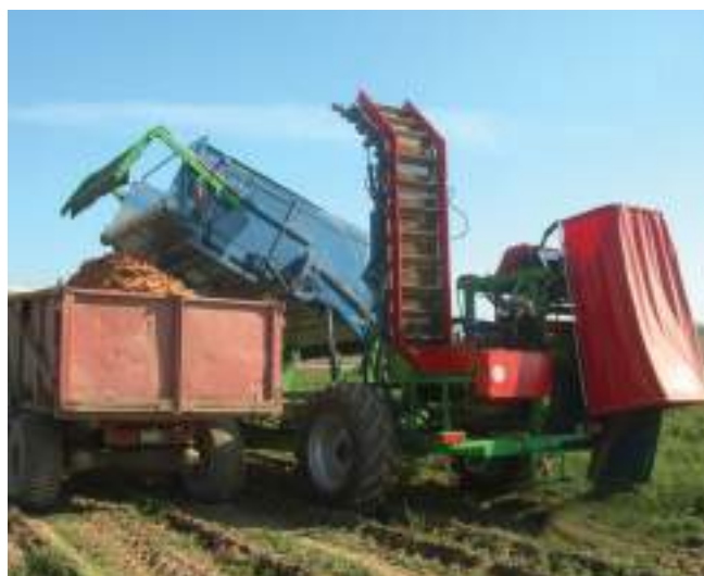
Рисунок 60,61. Комбайн теребильного типа для уборки моркови КТМ-1
