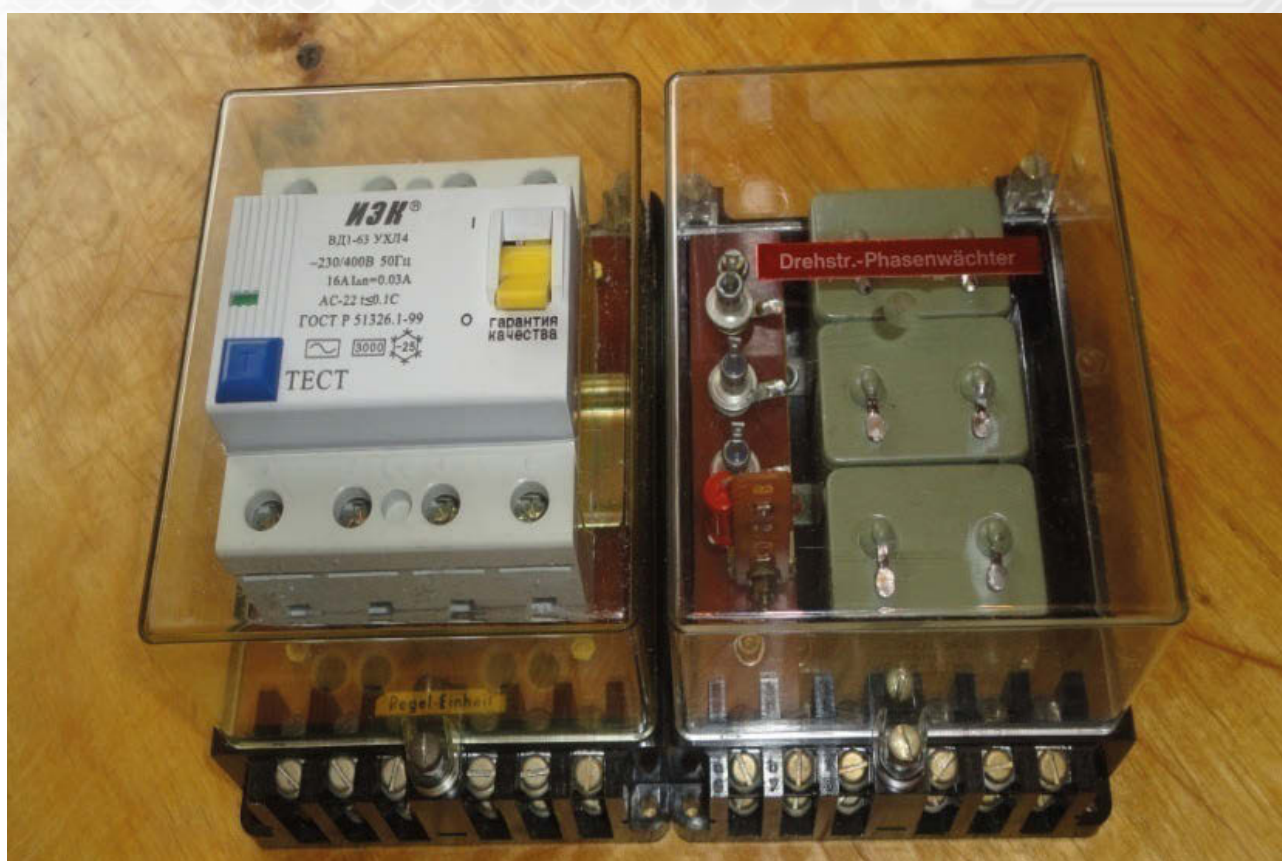
Рис.3 - Внешний вид комбинированного устройства защиты
