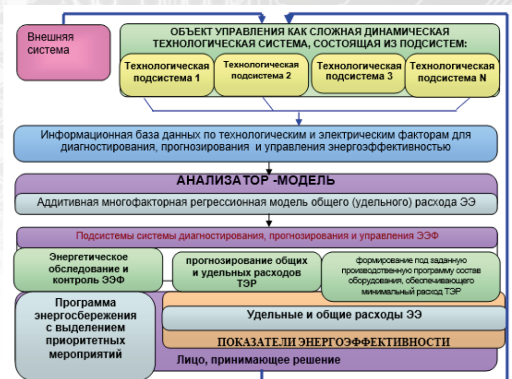
Рисунок 1 – Организация системы диагностирования, прогнозирования и управления ЭЭФ
